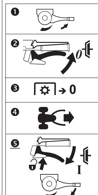
**i** Der Rückwärtsgang kann nicht eingelegt werden, wenn das Hackwerk angebaut und der Zapfwellenantrieb eingeschaltet ist (Rückfahrschaltsperrre) - erst Zapfwellenantrieb ausschalten, dann Rückwärtsgang einlegen!
