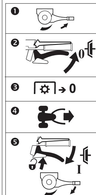
**(i)** Niet in achteruit zetten, als het hakwerk aangebouwd is en de aftakasaandrijving ingeschakeld (achteruitschakelblokkering) - eerst de aftakasaandrijving uitschakelen en pas dan in achteruit zetten!
