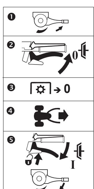
**i** Le verrouillage de marche arrière ne permet pas de passer la marche arrière lorsque le mécanisme de binage est monté et lorsque la prise de force est connectée - avant de commuter en marche arrière déconnecter la prise de force!
